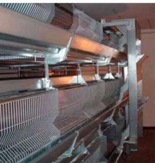
**Suministran un piso especial:** un alambrado de 17 x 17 mm , diseñado de tal forma que se evitan heridas en el pecho.
